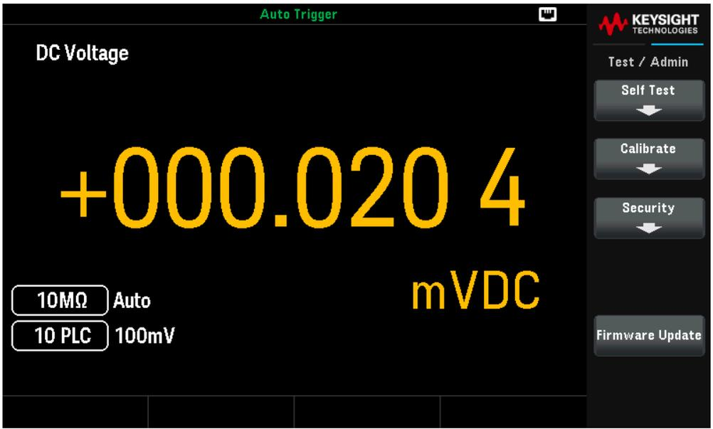
Self Test에서는 계측기 작동의 성능이 저하되었는지 확인합니다. 이 자가 테스트는 \*TST? SCPI 쿼리와 동일하므로, 테스트를 실행하기 위해 계측기에 대한 입력을 제거하지 않아도 됩니다.
